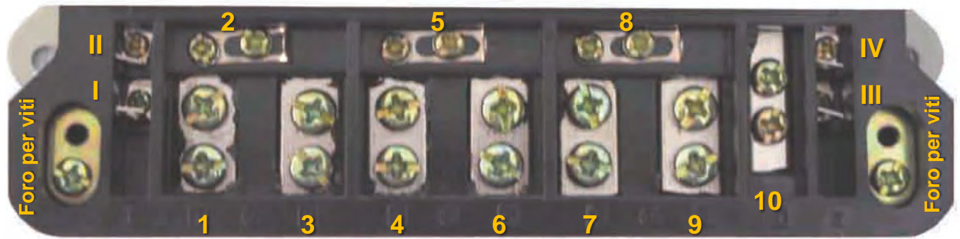
Numerazione dei contatti sulla morsetteria del DTS.
