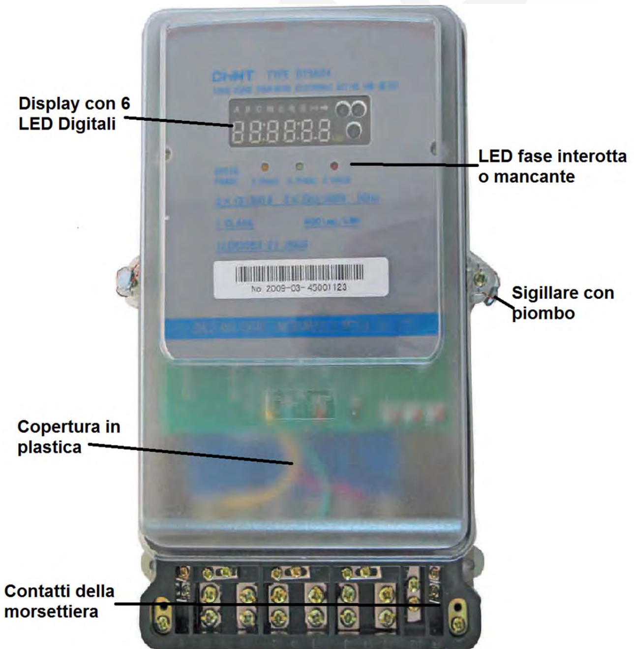
Schema delle parti e componenti del dispositivo DTS.
