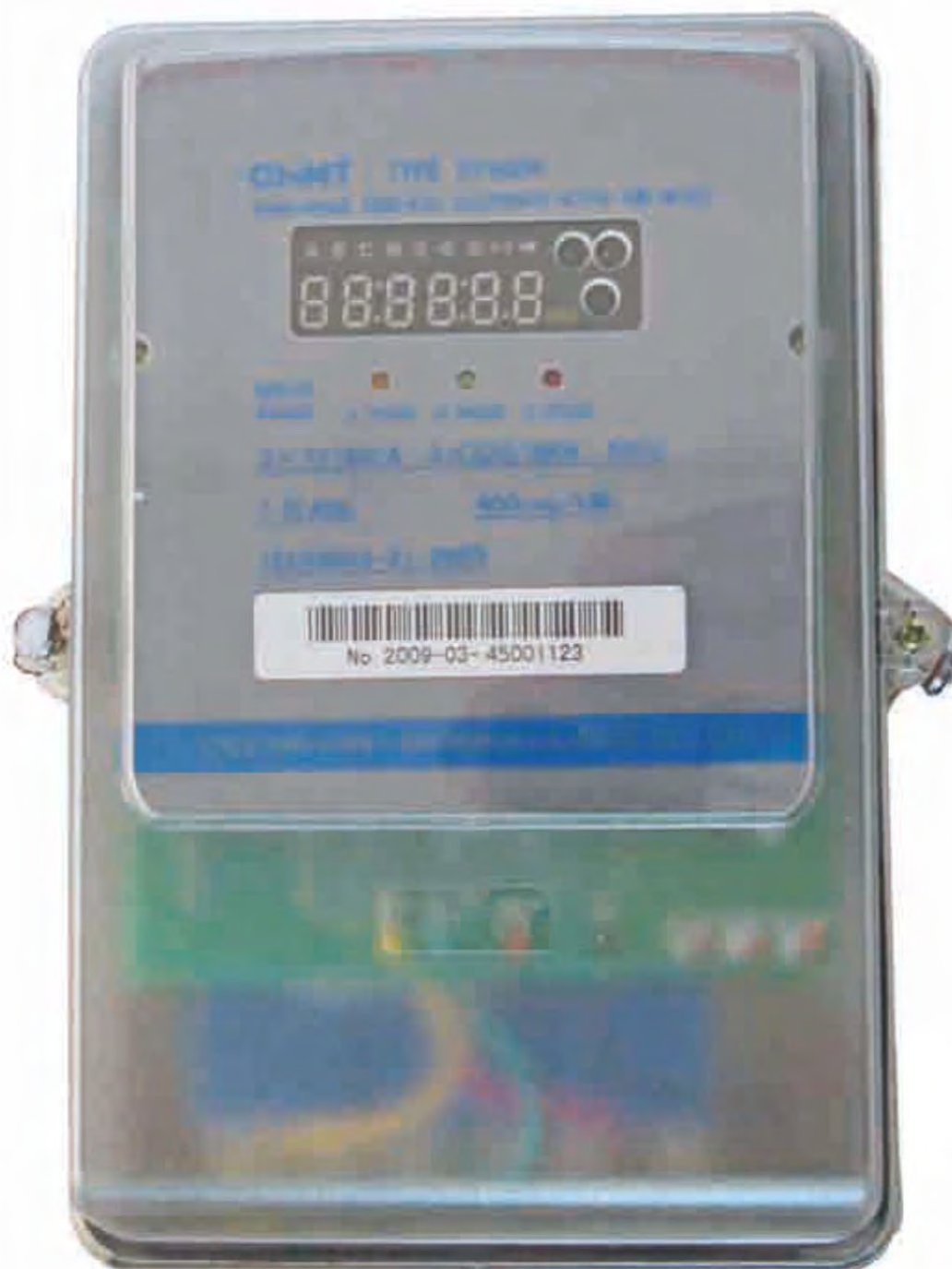
Aspetto della copertura frontale in plexiglass del DTS.
