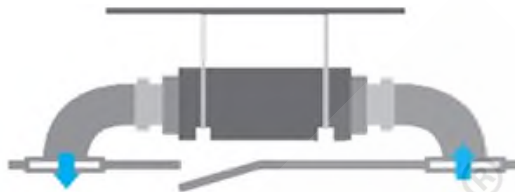
Presa d'aria posteriore e mandata diretta (STANDARD)
