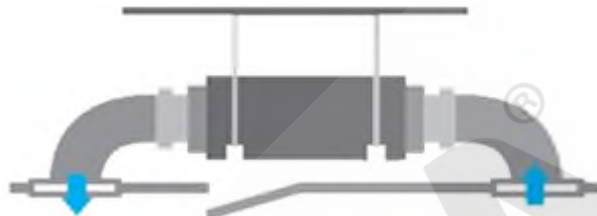
Preso d'aria posteriore e mandata diretta (STANDARD)
